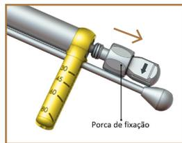
Retire el eje central del torquímetro.
